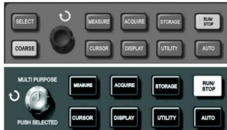
Figura 2-28 Tecla de Función mediciones automáticas
